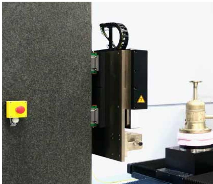
**Größter und leistungsstärkster Computertomograph in Österreich:** Prüfmöglichkeit für Bauteile von 1100mm Ø x 1675 mm Höhe, Bauteilgewicht bis 200kg, 2 Röntgenröhren mit Spannungen von 300 kV und 450 kV, unterschiedliche Detektoren zur Bauteildigitalisierung
